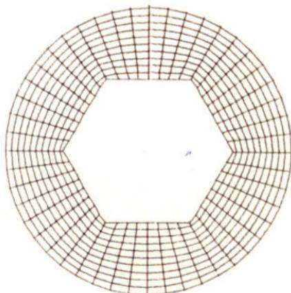
Figura 5 - Geometria duplamente conexas discretizada
