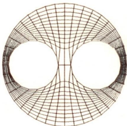
Figura 6 - Geometria multiplamente conexas discretizada
