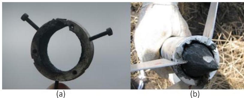
FIGURA 11. Conectores do PLUG avariados. Legenda: Lançamentos P-21 (a) e lançamento P-22 (b). Fonte: GFCS (2019).
