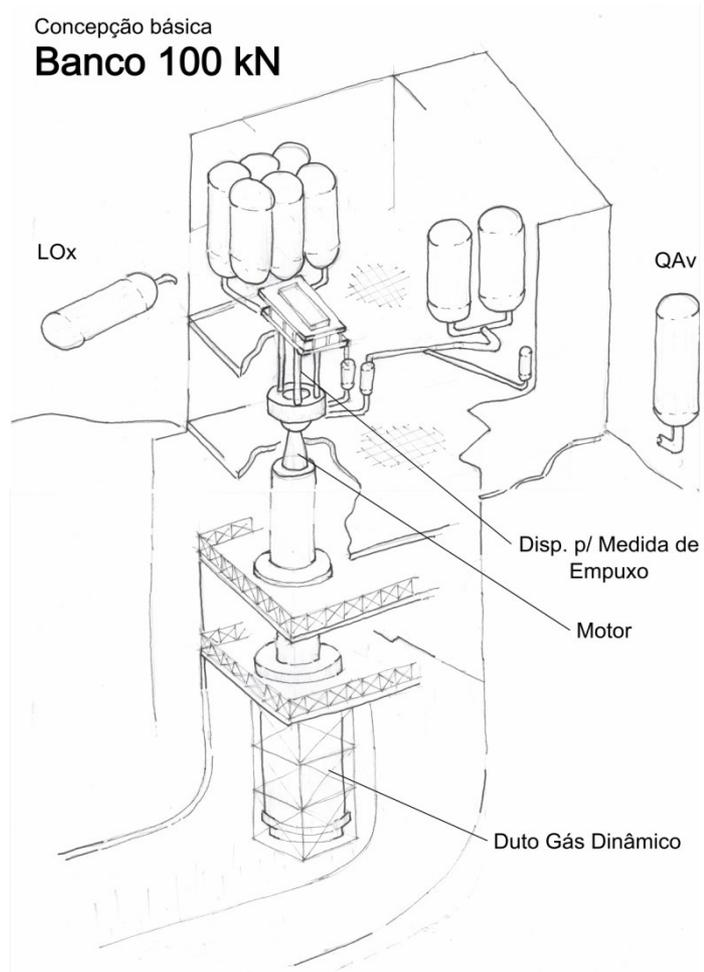
**Aplicação:** Ensaio de desempenho a quente da Câmara de Empuxo, TPU e do Motor L75.
