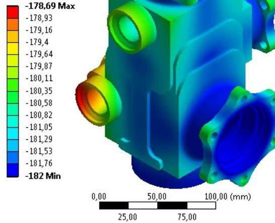
Distribuição de temperatura para o Corpo do Bloco de Válvula Oxidante
