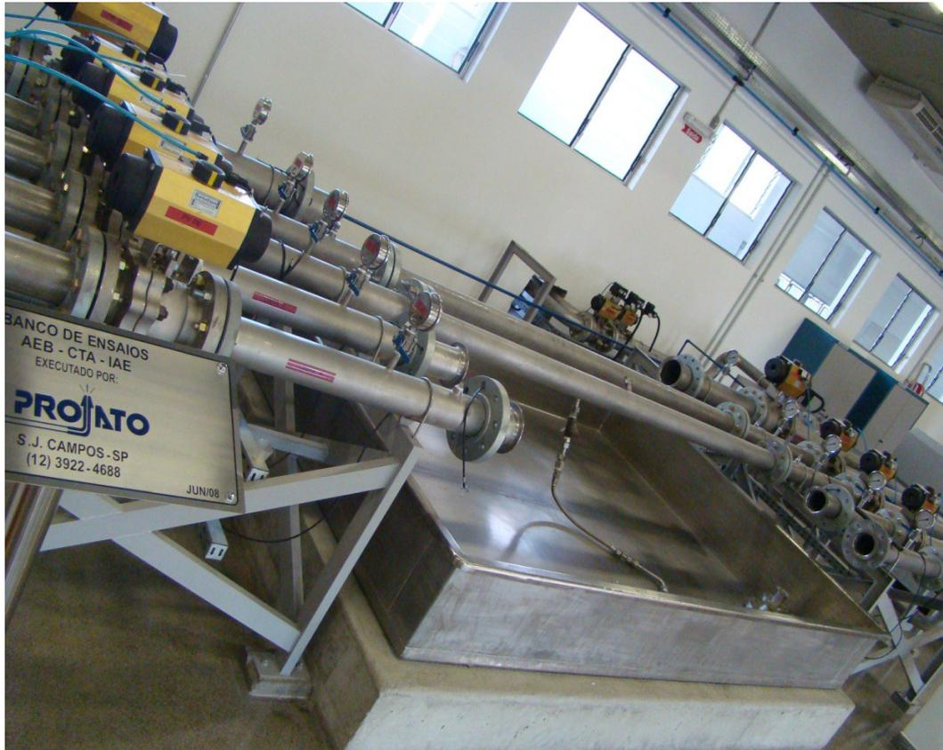
Aplicação: determinar  $\Delta P$  e vazão em regime permanente das válvulas, reguladores, câmaras de empuxo e gerador de gás.
