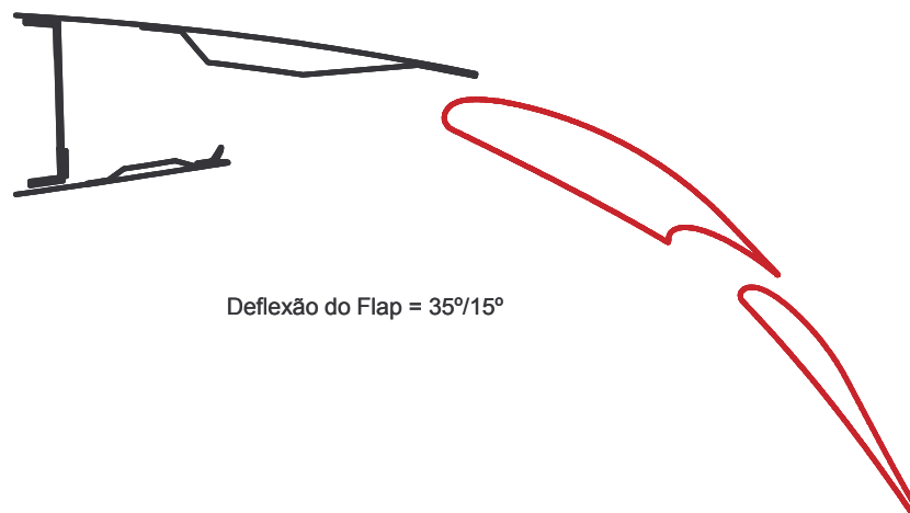
Figura 8-6 - Exemplo do mecanismo do flap de fenda dupla
