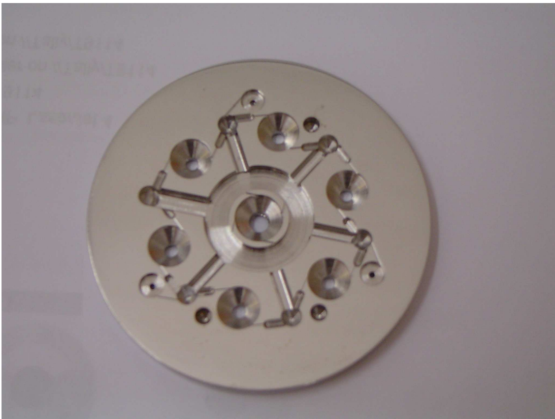
Figura 5: Face da placa de combustível contendo as câmaras de vórtice e os labirintos de distribuição
