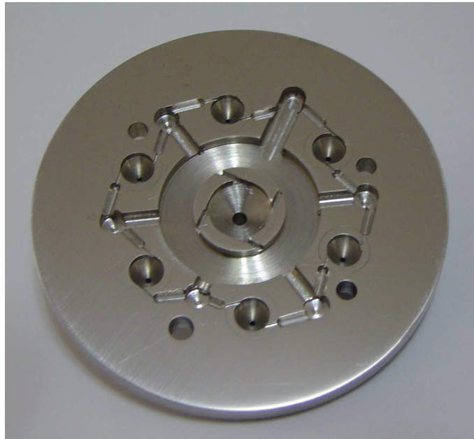
Figura 3: Face superior da placa de oxidante contendo as câmaras de vórtice e os labirintos de distribuição
