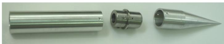
Figura 20 – Cone-cilindro desmontado
