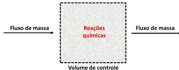
**Figura 10 - Diagrama representando o fluxo de massa do volume de controle considerado, sem o acúmulo de massa e nem o seu consumo.** Fonte: O autor (2017).
