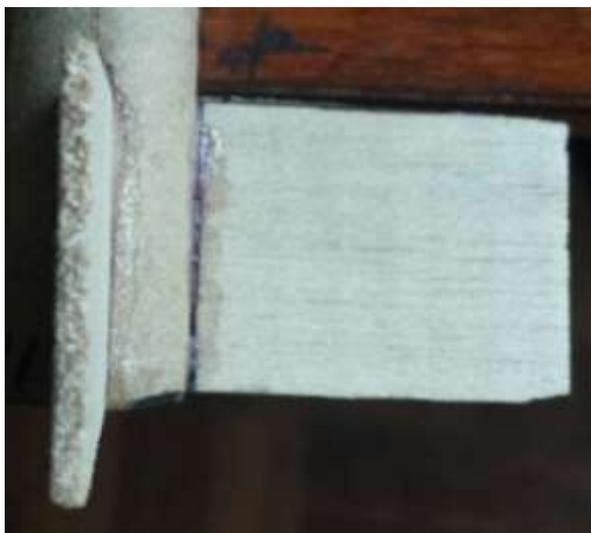
**Figura 4.16 – Empena Retangular utilizada nas versão V1 dos modelos.**
