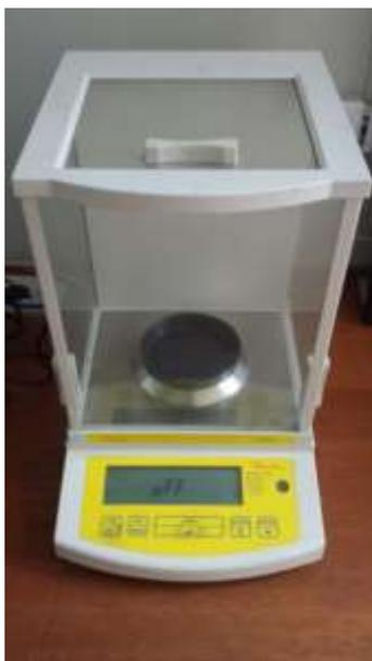
**Figura 4.3 – Balança digital Marte, modelo AY220.**
