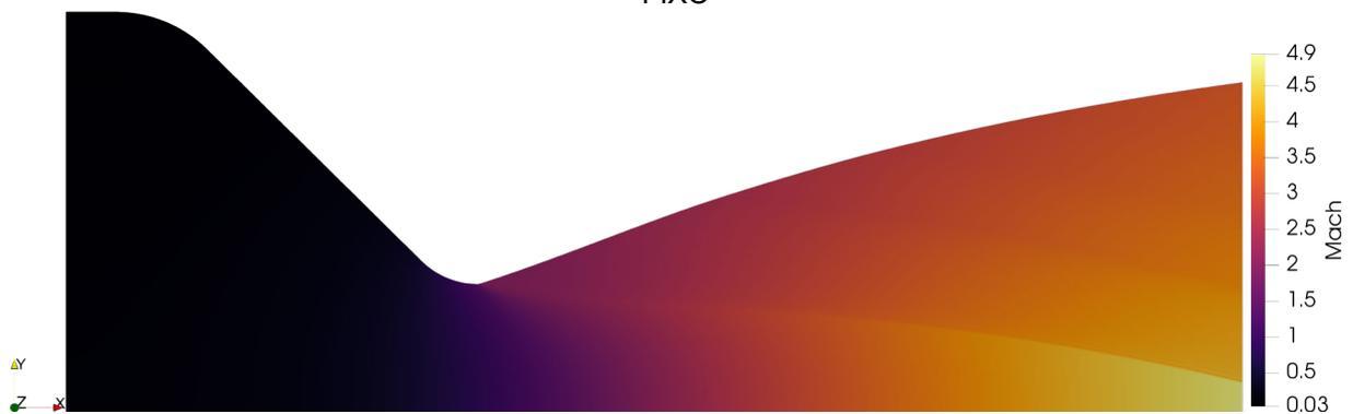
FIGURA 20 – CAMPO DE PRESSÃO PARA O PERFIL COM  $N = 4$  E RAIOS DE SAÍDA FIXO
