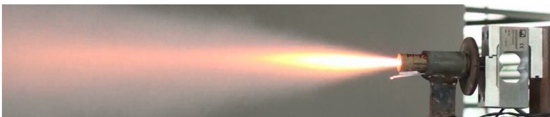
Figura 9. Foto mostrando o motor BT-72 (B6-0) durante o seu teste estático.
