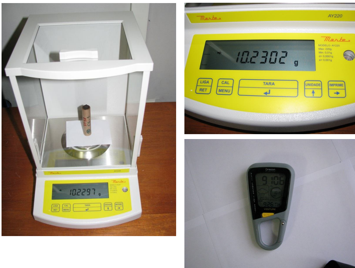
Figura 5. Fotos mostrando a balança e o medidor de temperatura e pressão usados.
