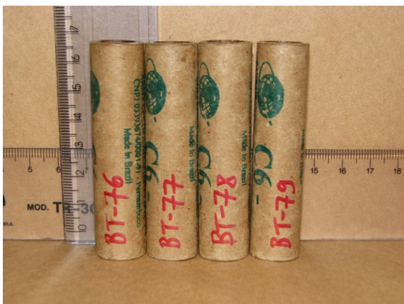
Figura 3. Fotos mostrando os motores-foguete BT-76 a BT-79 do tipo C6.
