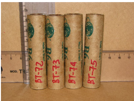
Figura 2. Fotos mostrando os motores-foguete BT-72 a BT-75 do tipo B6.
