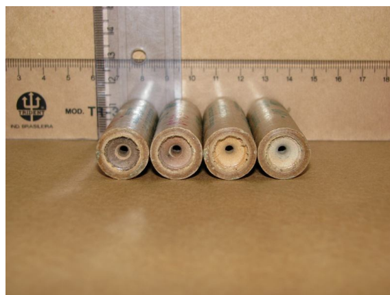
Figura 2. Fotos mostrando os motores-foguete BT-72 a BT-75 do tipo B6.
