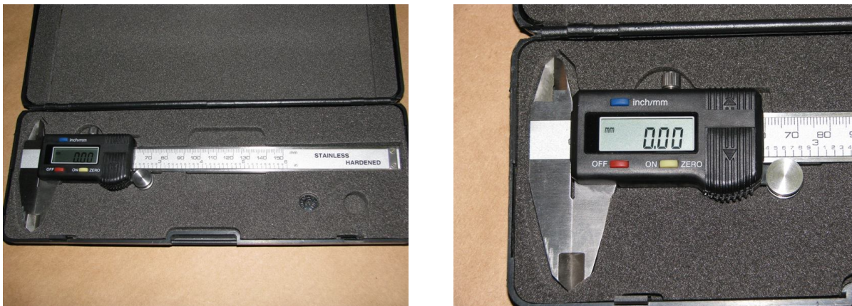
Figura 4. Fotos mostrando o paquímetro digital Lee Tools usado nas medições.
