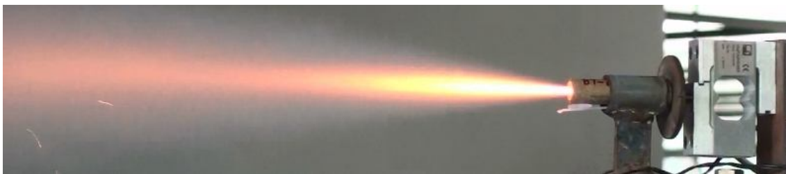
Figura 8. Foto mostrando o motor BT-68 (A6-0) durante o seu teste estático.
