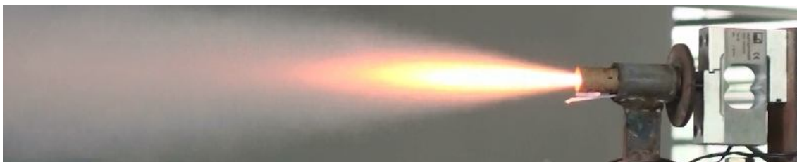
Figura 10. Foto mostrando o motor BT-76 (C6-0) durante o seu teste estático.
