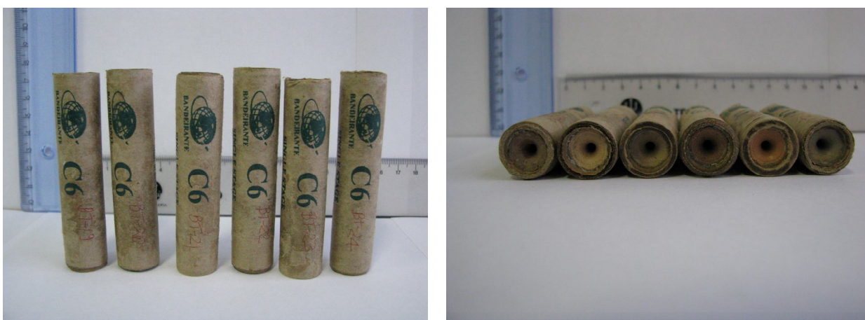
Figura 3. Fotos mostrando os motores-foguete BT-19 a BT-24 do tipo C6.
