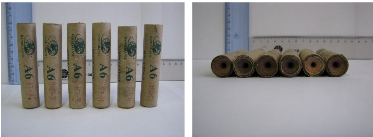
Figura 1. Fotos mostrando os motores-foguete BT-7 a BT-12 do tipo A6.
