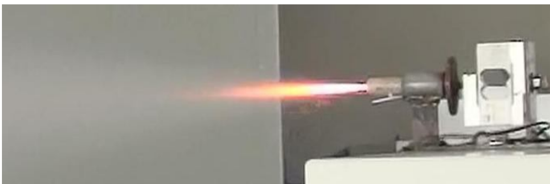
Figura 7. Foto mostrando o motor BT-7 durante o seu teste estático.
