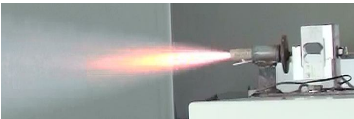
Figura 8. Foto mostrando o motor BT-14 durante o seu teste estático.
