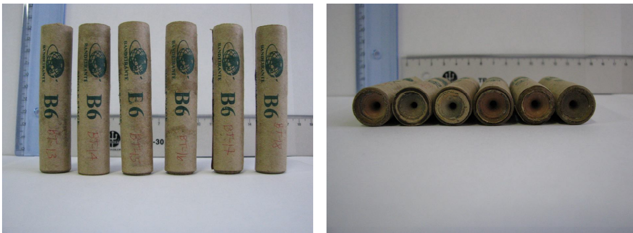
Figura 2. Fotos mostrando os motores-foguete BT-13 a BT-18 do tipo B6.
