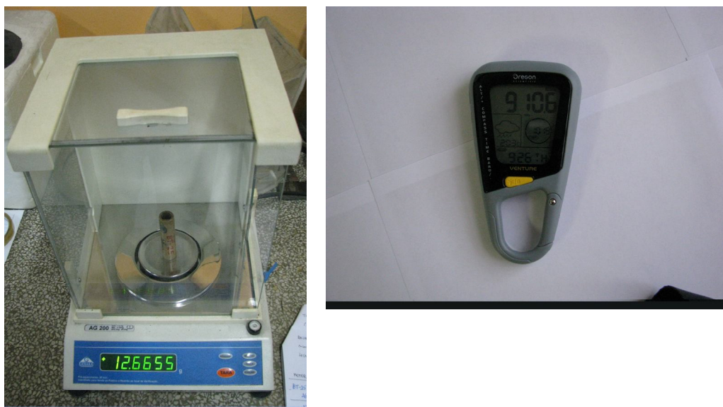
Figura 4. Fotos mostrando a balança e o medidor de temperatura e pressão usados.
