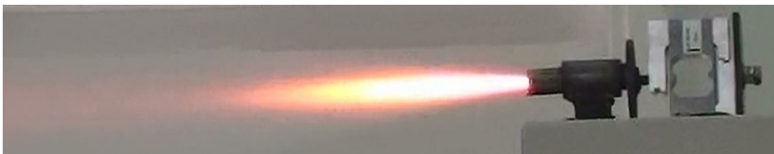
Figura 9. Foto mostrando o motor BT-37 durante o seu teste estático.
