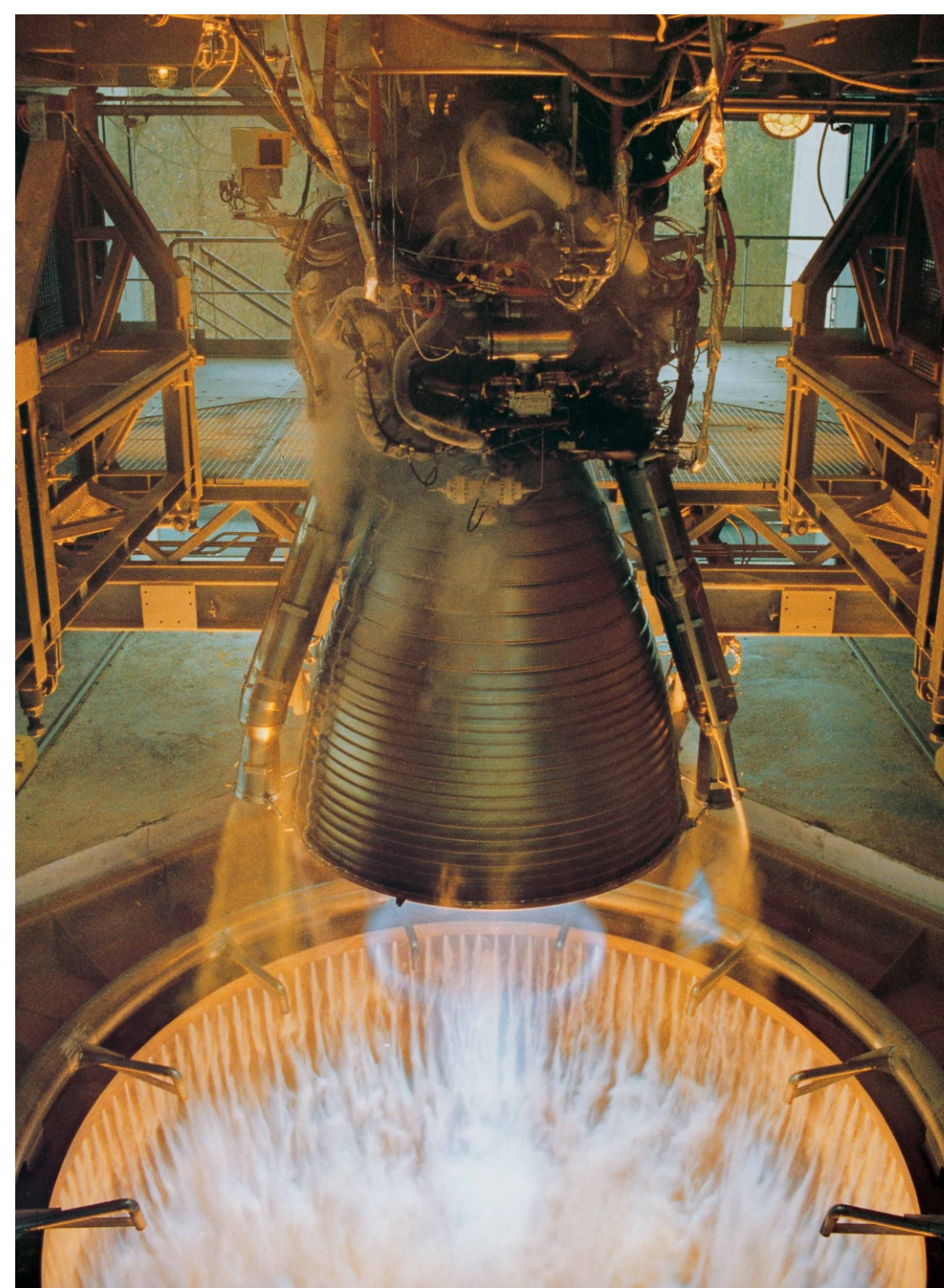
Motor Vulcain (Ariane V), na bancada de testes. [Fonte: DRL Bild-Datenbank, http://bilddb.rb.kp.dlr.de/ ]
