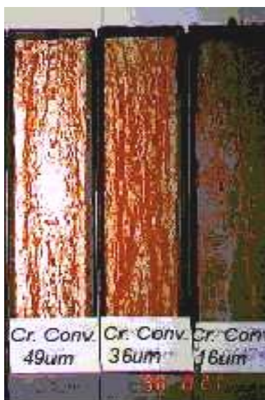
Figura 5 – Corrosão de cdp's de cromo duro
