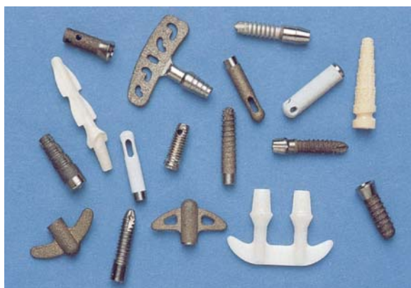
Figura 11 Principais geometrias e acabamentos superficiais de implantes disponíveis (SPIEKERMANN, 1995).
