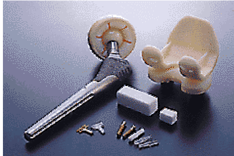
Figura 4 Prótese de fêmur de titânio com cabeça de alumina.
