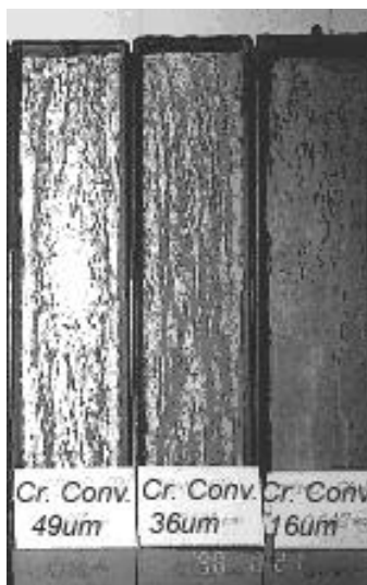
Figura 3. Corrosão de corpos de prova de cromo duro.
