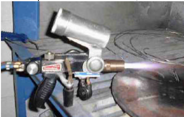
Figura 7 - Pistola de AT à Chama Oxiacetilênica - alimentada com pó através da gravidade
