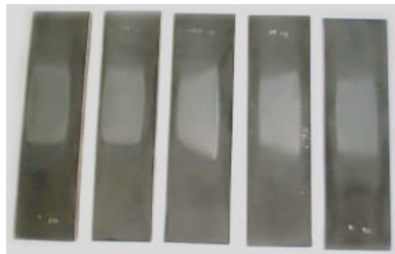
Figura 3. Padrões gerais de desgaste no ensaio de abrasão (50% do tamanho original)
