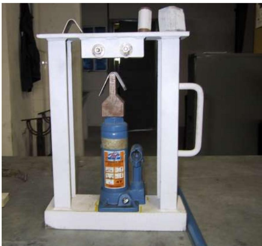
Figura 3. Equipamento de medição da aderência por dobramento, segundo norma MIL 2138 A [18].
