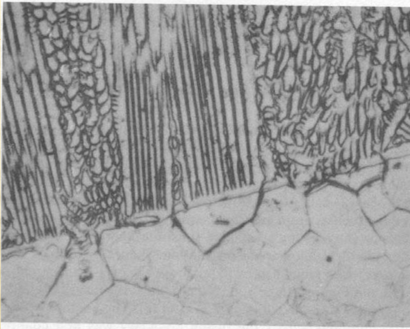
Crescimento epitaxial na linha de fusão de uma solda sobre chapa no aço maraging 18-Ni-250 (magnificação X250). De Savage (6).
