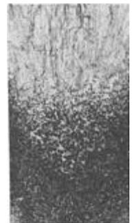
**Ledeburita:** Ao solidificar no eutético, ocorre a formação de um fundo de carbonetos ( $Fe_3C$ ) em dendritas de Austenita (com 2,0%C). Ao resfriar abaixo de 723°C, a austenita é transformada em Perlita, sendo a Ledeburita conceituada como: **Nódulos de Perlita em fundo de Cementita**.
