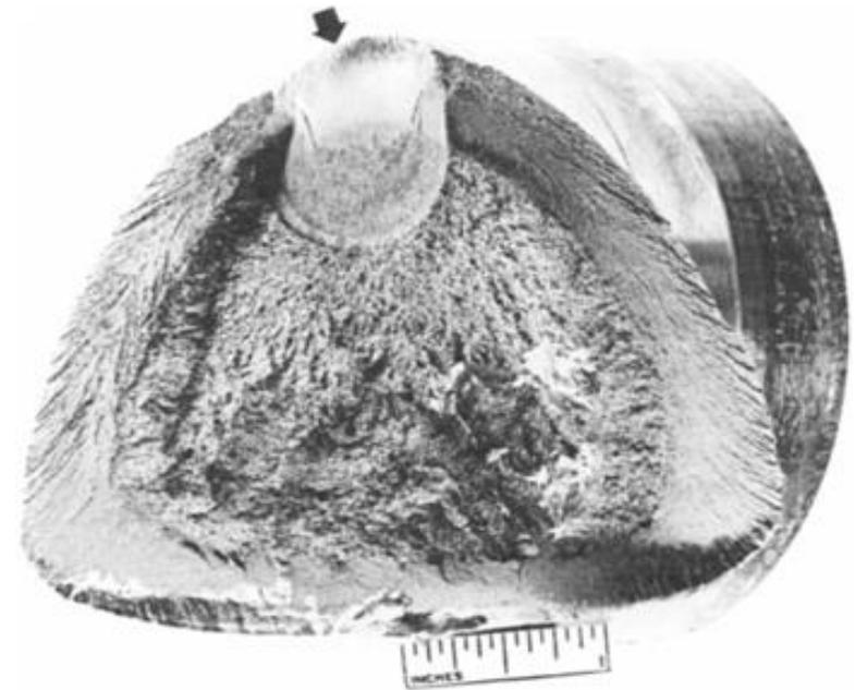
**Fratura em Aço Endurecido por Indução. Fadiga a partir de raio de concordância originou a fratura frágil.**
