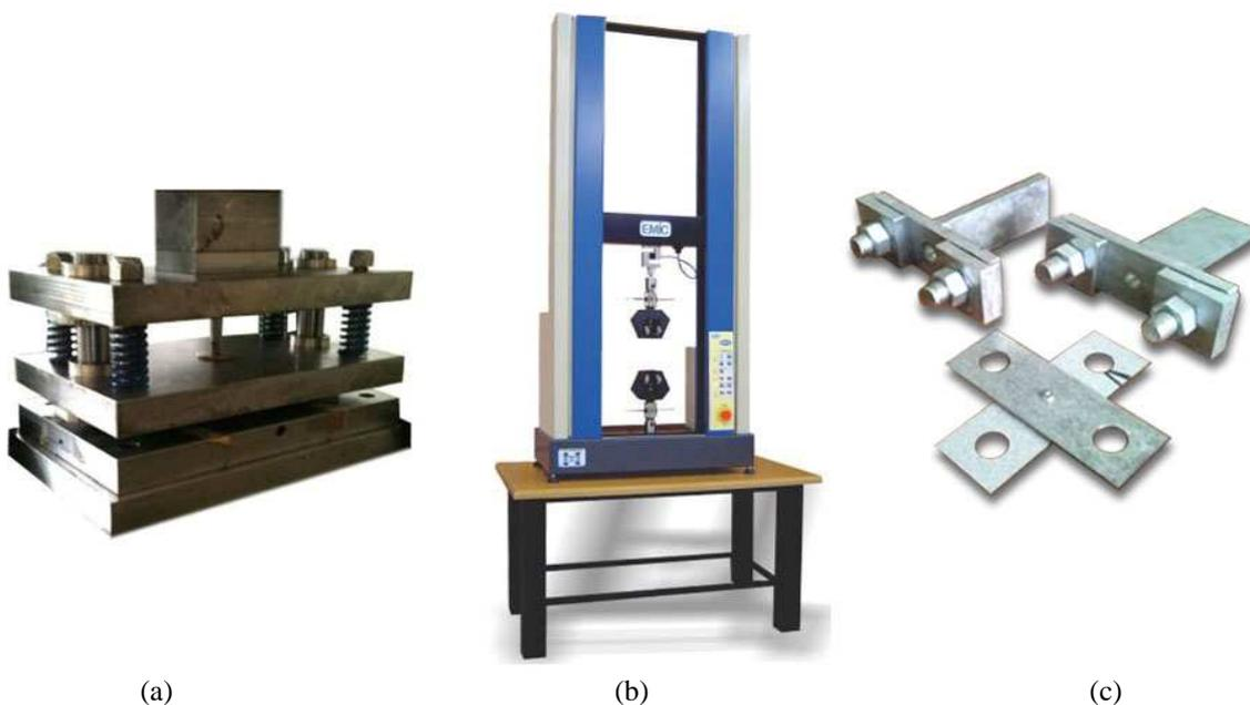
Figura 4. Equipamento de ensaios de *clinch*ing; em (a) porta-ferramenta, em (b) máquina de ensaio uniaxial de tração e em (c) dispositivo para ensaio de arrancamento.
