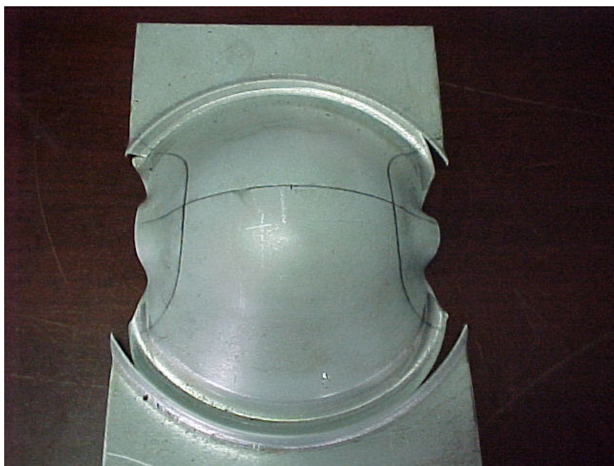
Figura 3: Corpo de prova 200 X 100 mm sem entalhe ensaiado
