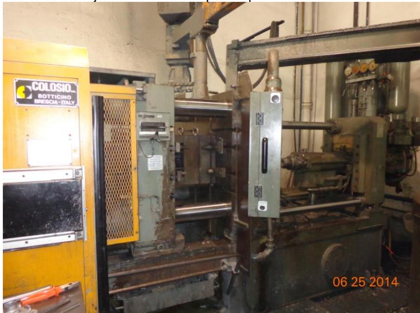
O ciclo de injeção inicia com a dosagem automática pelo forno da carga de alumínio a ser injetada na bucha de injeção. Ao injetar o alumínio, o produto se solidifica, a injetora e o molde se abrem para que o robô retire pelo canal de alimentação o produto do molde. Durante este processo, foi necessária a aplicação de desmoldante na matriz do molde por um mecanismo na parte superior da injetora, esse recurso é importante, porque o alumínio agarra na superfície da matriz, dificultando a
