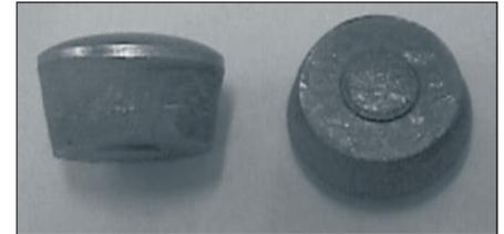
Figura 7 - Forma cônica dos retalhos no puncionamento de chapas grossas de aço de alta resistência (chapa de aço NBR 6656 LNE 38, 8mm de espessura)
