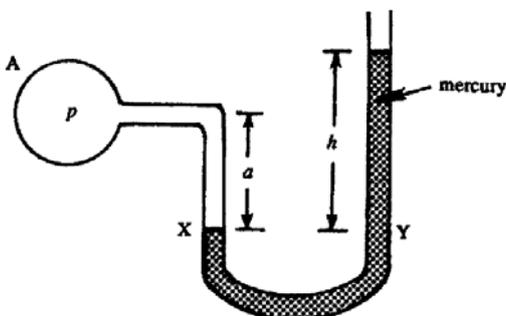
4. A Figura ao lado mostra um manômetro, no qual o tubo em forma de U contém mercúrio de densidade  $\rho_m$ . Manômetros são empregados medição de pressão; se o fluido no tanque A possui pressão  $p$  e massa específica  $\rho$ , mostre que a pressão manométrica no tanque é
