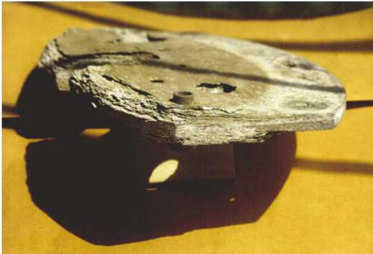
Parte de flange deteriorado por esfoliação
