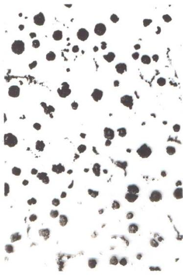
FIGURA 95 – Ferro fundido nodular, corpo-de-prova de 100 mm de diâmetro. Ataque: Nital (2%), 100 X
