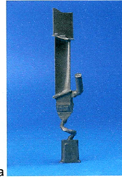
Lâmina monocristalina à base de níquel para a turbina (a) de um motor à jato (b)
