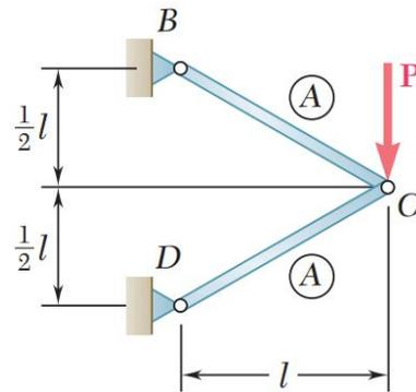
**Exercício 5.2** - Determine o deslocamento horizontal da junta  $C$ . Considere um módulo de elasticidade  $E$  e áreas de seção transversal conforme indicado na figura abaixo. [Resposta:  $\delta_{C,h} = \frac{Pl}{2EA}$  (para esquerda)]
