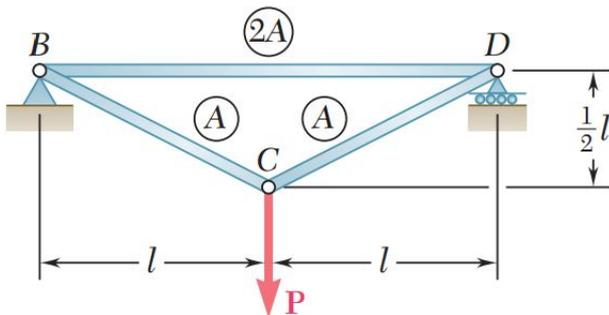
**Exercício 5.4** - Determine o deslocamento horizontal do ponto  $B$ . Cada barra possui área de seção transversal  $A = 500 \text{ mm}^2$  e  $E = 200 \text{ GPa}$ . [Resposta: Por Castigliano  $R_{AX} = -0,5P - 5$ ;  $R_{DX} = -0,5P + 5$ ;  $F_{CB} = 6.06 \text{ kN}$  (tração); ...]
