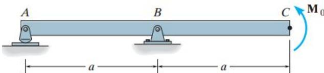
**Exercício 5.8** - Determine a inclinação e o deslocamento da extremidade  $C$ . Considere que a viga tenha um módulo de elasticidade  $E$  e que os segmentos  $AB$  e  $BC$  possuam momentos de inércia de área  $2I$  e  $I$ , respectivamente. [Resposta:  $\theta_C = \frac{5PL^2}{16EI}$ ;  $\delta_C = \frac{3PL}{16EI}$  (para baixo)]
