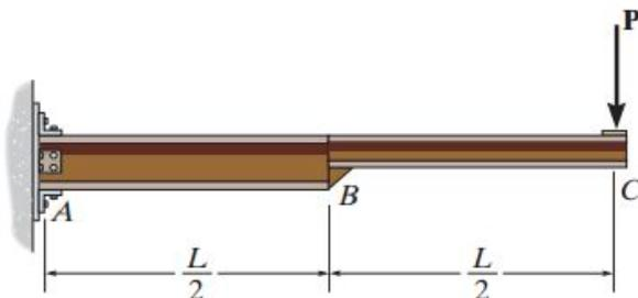
**Exercício 5.9** - Determine a inclinação no ponto  $C$ . Considere  $E = 13.1$  GPa e a seção transversal conforme indicado abaixo. [Resposta:  $\theta_C = 5.89 \times 10^{-3}$  rad]
