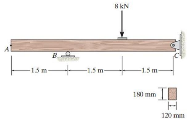
**Exercício 5.10** - Determine a deflexão na extremidade  $A$ . Considere  $E = 13$  GPa e a seção transversal conforme indicado abaixo. [Resposta:  $\delta_A = 57.9$  mm]
