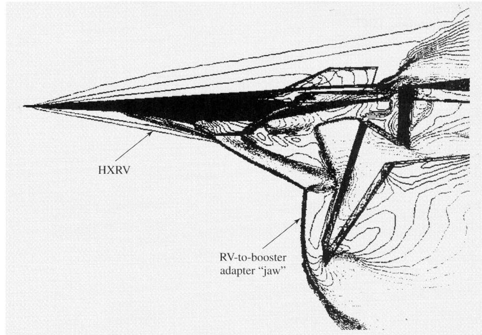
Solução numérica para o padrão de ondas de choque sobre o veículo hipersônico de pesquisa Hyper-X da NASA no instante da separação do veículo lançador a Mach 7 (Griffin Anderson, Charles McClinton, e John Weidner, "Scramjet Performance", in *Scramjet Propulsion*, editado por E. T. Curran e S. N. B. Murthy, AIAA Progress in Astronautics and Aeronautics, vol. 189, Reston, Virginia, p. 431.)
