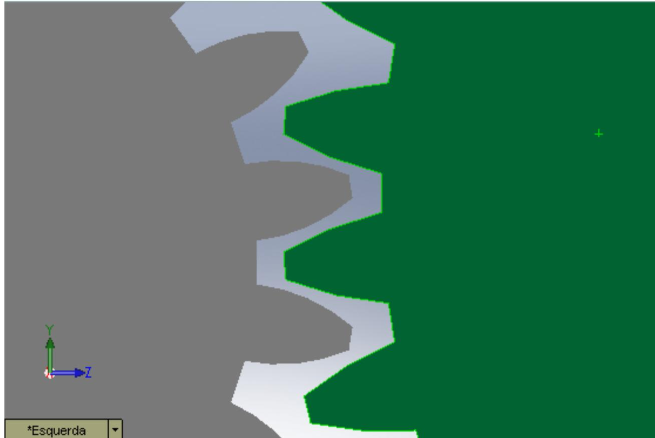
**Exemplo de engrenagem de passo diametral  $P = 2$ ,  $N = 20$  e  $N = 40$  respectivamente.**
