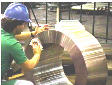
Remoção do penetrante com pano
