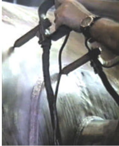
Uso da técnica de eletrodos para inspeção de uma solda de conexão
