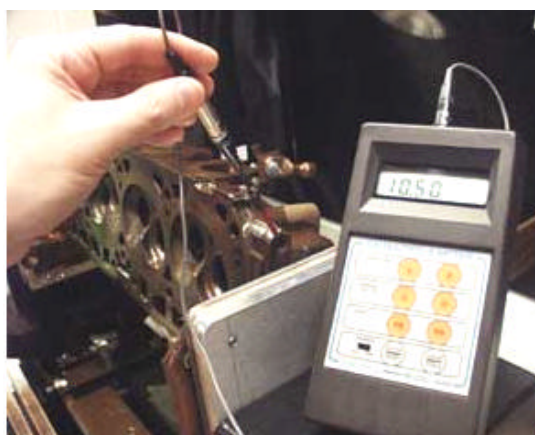
Aparelhos para avaliação do campo magnético residual. Gaussímetro (da esquerda) e o Medidor de Campo ( da direita)
