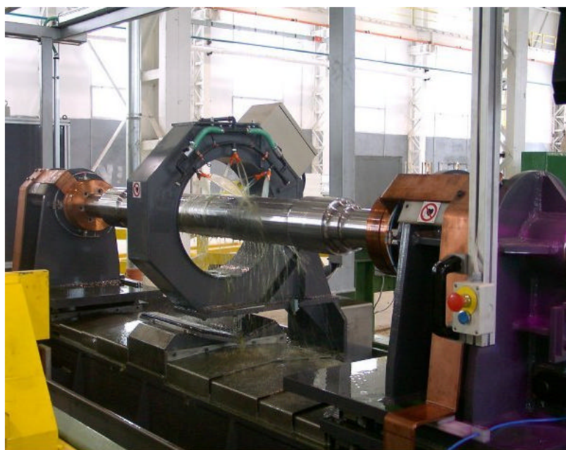
Unidade estacionária de inspeção por partículas magnéticas via úmida de eixos de grande porte
