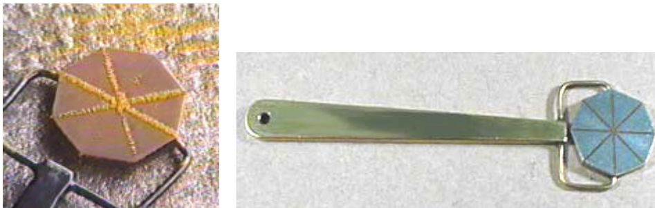
Padrão indicativo de Campo Magnético recomendado pelo Código ASME Sec.V Art.7 , ASTM E-709 e ASTM - E 1444
