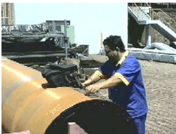
Inspeção por ultra-som da chapa de um tubo
