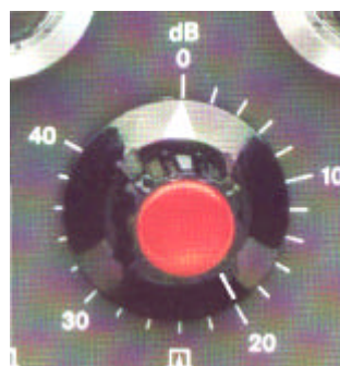
Ajustado em 20 dB. Eco na tela em 80% da altura
