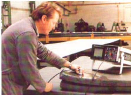
Delimitação da extensão de uma dupla laminação em uma chapa, usando a técnica da queda do eco em 6 dB , com transdutor normal.
