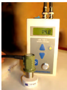
Medidor de Espessura Digital Ultra-sônico (foto extraída do website Eddytronic)
