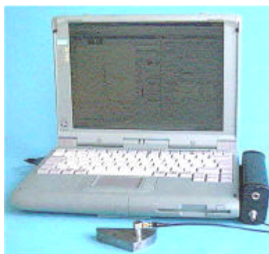
Aparelho de ultra-som marca SONATEST à esquerda e um notebook que incorpora uma placa de ultra-som industrial Krautkramer.
