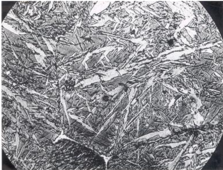
Figura 39 - Martensita do tipo acicular (“acicular or plate martensite”), (Metallographic supplies – P.F. Dujardin & CO. Düsseldorf, 1958).
