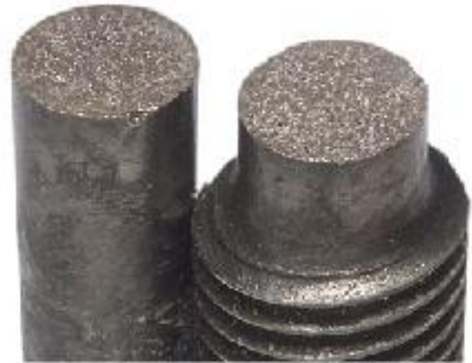
Fratura frágil (aço)
