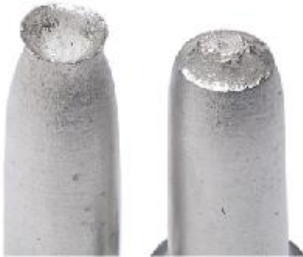
Fratura tipo taça e cone (Al)
