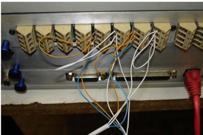
Figura 75 – Ligação dos cabos na placa de aquisição.
