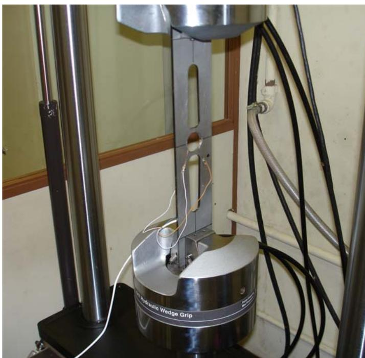
Figura 76 – Corpo de prova durante ensaio de tração.
