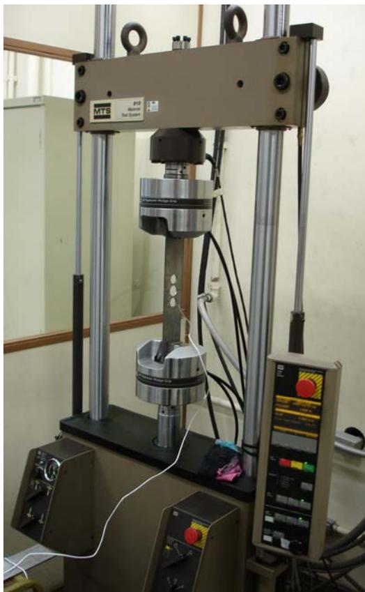
Figura 72 – Máquina de tração utilizada na análise experimental.
