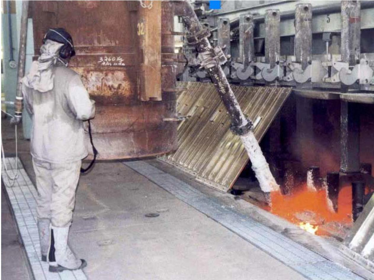
Controlando forno de redução eletrolítica na fábrica ALBRÀS, em Barcarena, Pará
