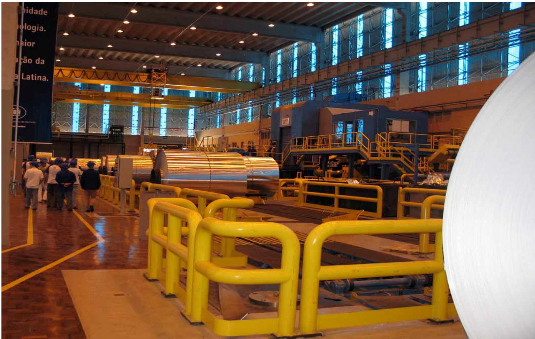
A linha de produtos inclui: laminados em **placas de várias dimensões e em bobinas, incluindo folhas de alumínio para utensílios e recipientes como bandejas tipo marmitex com espessura de 35 micra, e folhas tipo papel para embalagem, com até 6 microns.**
