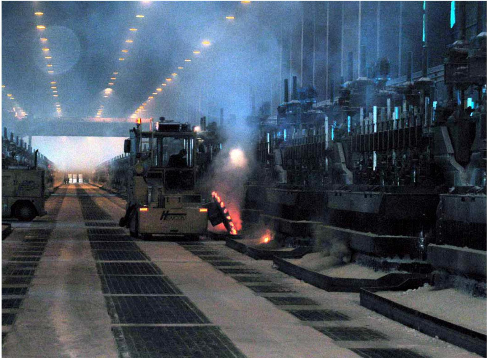
*Quando os gases formados na reação não são devidamente aspirados pelas coifas nem devidamente queimados pelos pequenos flares, acabam se acumulando entre o fundente e a crosta, podendo explodir e, quase sempre “isolando” parcialmente a corrente elétrica; aí, o sistema dá o alarme, o trator-ferramenta deve quebrar a casca de mistura mais fria acima da massa fundente, e assim retomar a condição correta.*
