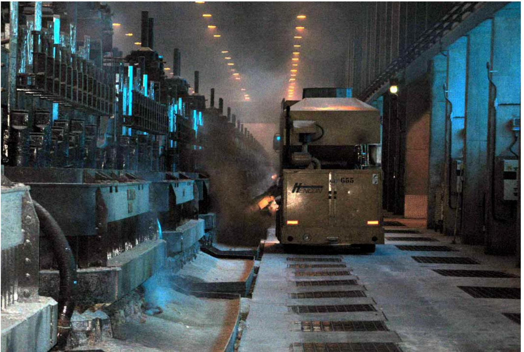
*Adição de carga suplementar de alumina  $Al_2O_3$  + criolita (sal composto de Fluor) para tampar “buracos” que aparecem na crosta.*
