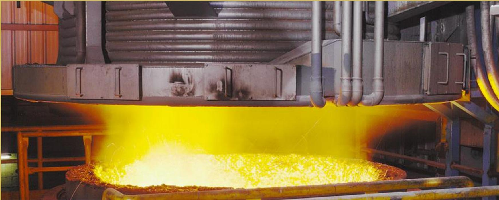
Onde é possível controlar a temperatura do metal líquido e, mediante injeção de gás inerte, propiciar a homogeneização térmica do metal e de todas as ligas de ferro adicionadas para formular o aço desejado na saída do Forno Elétrico. Ao mesmo tempo ocorre o refino secundário, momento em que acontece a desoxidação e a dessulfuração.
