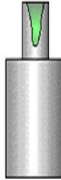
rechupe compensado por alimentador (massalote)
