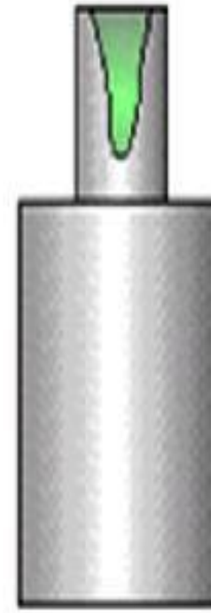
rechupe compensado por alimentador (massalote)
