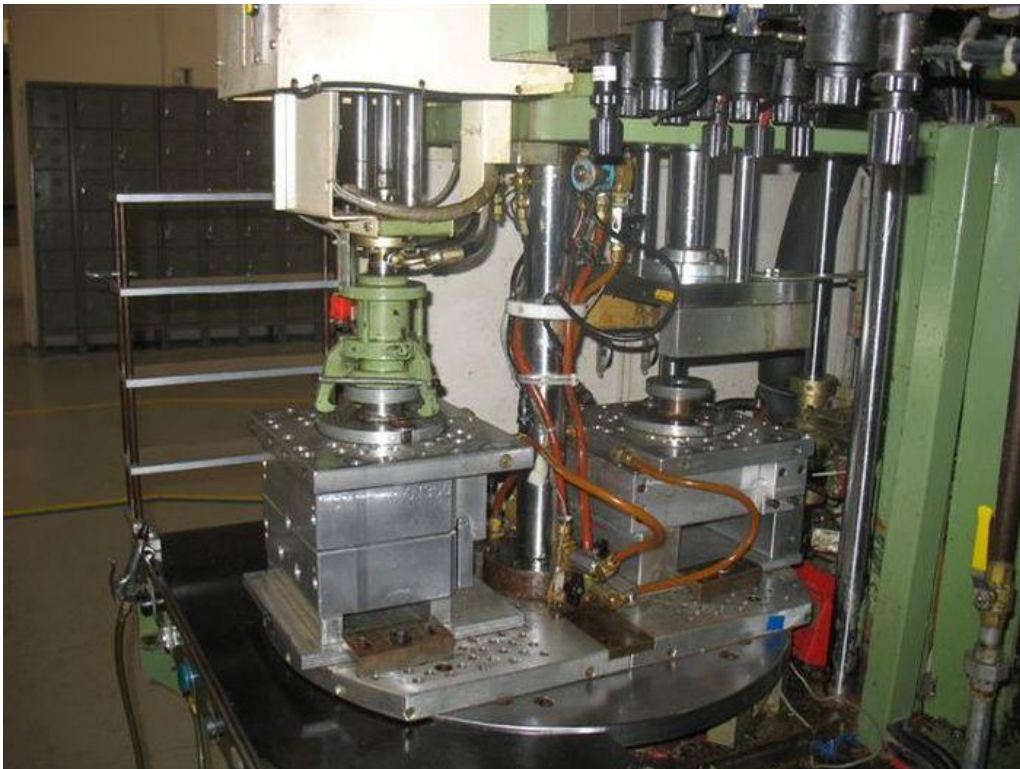
Figura 5 - Máquina de injeção de cera
