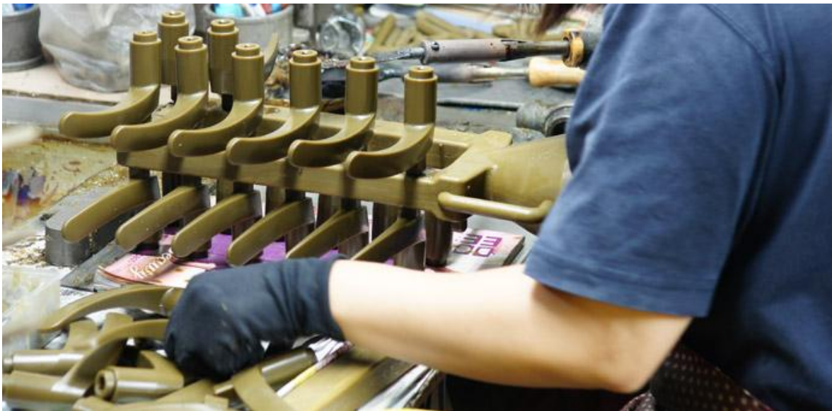
Figura 7 - Confecção de árvore de modelos
