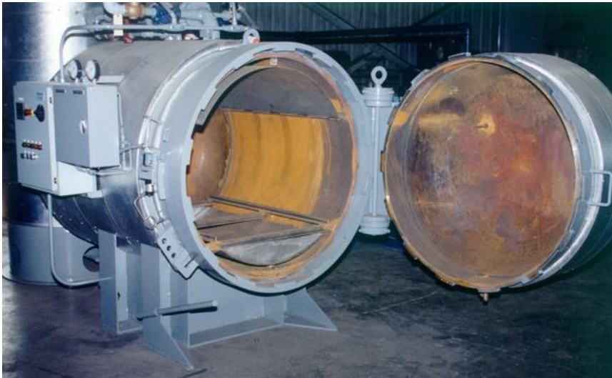
Figura 9 - Autoclave para deceragem
