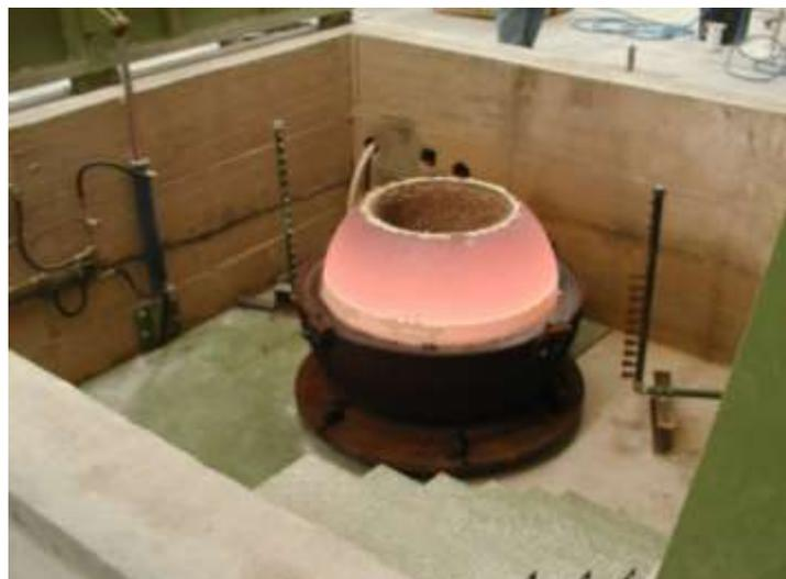
Figura 11 - Peça fabricada por centrifuga vertical com resfriamento por água
