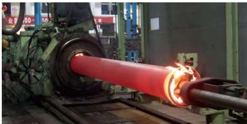
Figura 15 - Fabricação de tubo de ferro dúctil por centrífuga móvel na SMT, China
