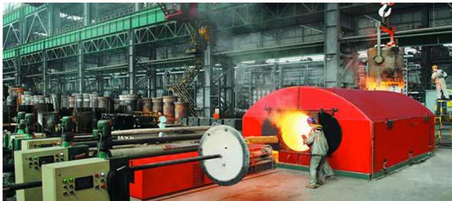
**Figura 13 - Centrífuga em operação na fábrica da Zhagun, na China**
