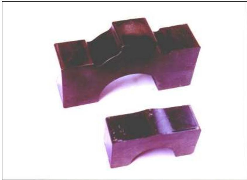
Figura 15 - Capas de mancal em ferros fundidos cinzento e nodular, obtidas por fundição contínua.
