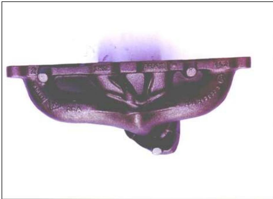
Figura 11 – Coletor de escapamento produzido em ferro fundido vermicular SiMo.
