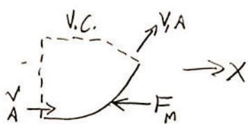
$F_M$  = força da roda a impedir a V.C. p/ montá-lo parado
