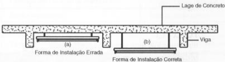
FIGURA 15.3 Posição das lâmpadas fluorescentes instaladas no teto
