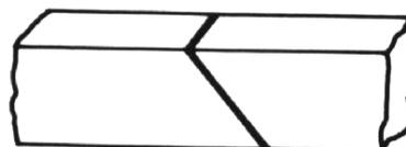
**Figura 8 :** Tipos de juntas brasadas.
