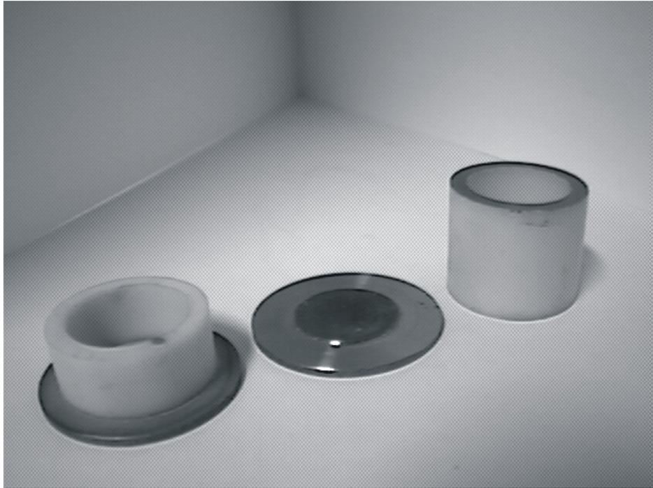
**Figura 5** : Brasagem entre cerâmica alumina e liga Fe-Ni-Co.
