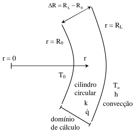
Figura 4.1: Esquema do problema físico
